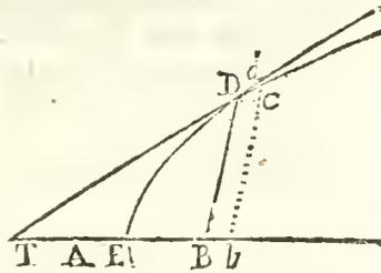
II. La Relation de BD à AB est donnée par l'Equation à la Courbe; cherchez par le Prob. 1. la Relation des Fluxions, & prenez  $TB$  à  $BD$  dans le Rapport de la Fluxion de AB à la Fluxion de BD; la Ligne TD touchera la Courbe au Point D.
